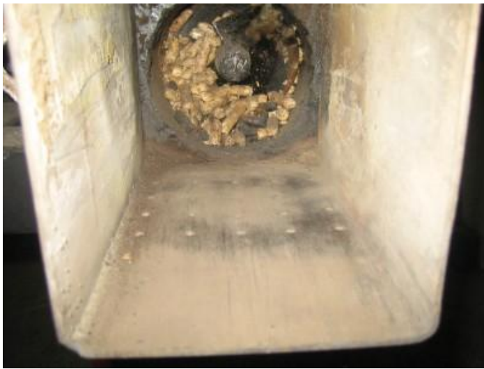
Brænderhoved med lufthuller i bund og top.
